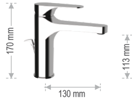
L 10 L Miscelatore monocomando lavabo alto L. L high basin mixer.
