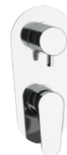
L 93 7 Miscelatore monocomando per doccia con deviatore a tre vie e sette posizioni (una entrata, tre uscite e sette posizioni con cui selezionare uscite singole o miscelate tra loro) su unica piastra.
