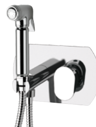
L 60 Miscelatore incasso per shut-off comprensivo di: doccetta shut-off art. 332OL, supporto doccia-presa acqua su piastra in ottone cromato e flessibile doccia cm 120. Built-in shower mixer set including: shut-off art. 332OL, shower holder-water punch on flange, all in c.p. brass and shower flexible cm 120.
