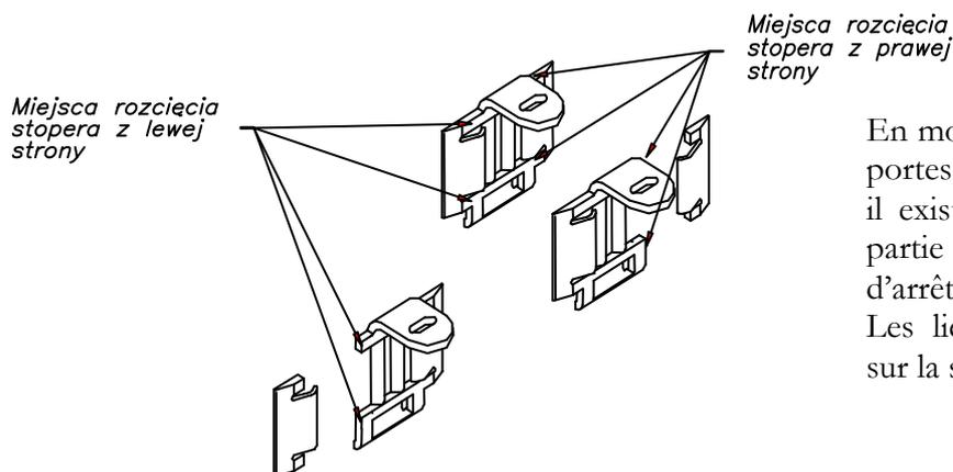
En montant une pièce d'arrêt pour les portes extérieurs: à gauche et à droit, il existe la possibilité de couper une partie gauche ou droite d'une pièce d'arrêt, ce qui est montré sur la figure. Les lieux du coupage sont indiqués sur la surface de la pièce d'arrêt.
