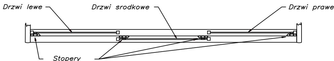
Pour la porte au milieu la pièce d'arrêt peut être installée du côté gauche ou droit de la porte.
