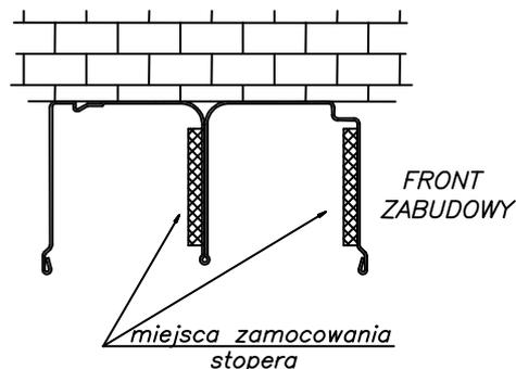
Dependement de la position des portes extérieures (gauche ou droite) et le genre du ferrage (standard ou lux) coupez la pièce d'arrêt selon le schémat défini. Au-dessous, on a présenté le schémat, en marquant les bords du coupage pour la porte ferrée avec les montants standard.
