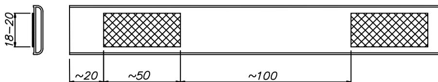
La démarche finale, c'est le collage de la traverse de décoration dans un lieu choisi. Le collage de la traverse sur la vitre ou le miroir ne pose aucun problème. La lèvre du joint provoque la diminution de la longueur de traverse de la façon qu'on peut la fixer dans un lieu quelconque du remplissage et entre des montants librement choisis.
