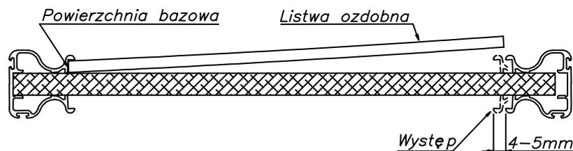
La figure ci-dessus présente la façon de collage de la traverse de décoration entre les montants (dans la position horizontale ou oblique). Pour coller la traverse il faut retirer le montant à distance de 4- 5 mm, de la façon que la traverse, après avoir été posée d'un bout au remplissage de base, puisse être collée facilement. Collez la traverse dans un lieu choisi et ensuite insérez de nouveau le montant détaché vers les bords de la traverse de décoration.
