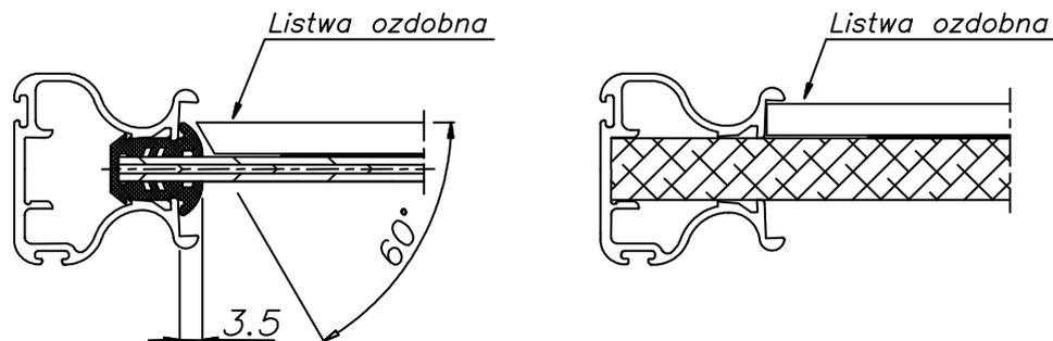
La traverse fixée sur la porte à remplissage en vitre ou en miroir devrait être coupée (chanfreinée) sur les bords à un angle de 60 degrés. C'est à cause du fait que la lèvre du joint s'étale sur la surface de base du montant (traverse). Sur la porte à remplissage en panneau les bouts de la traverse de décoration sont coupés à un angle droit. (Figure 14).
