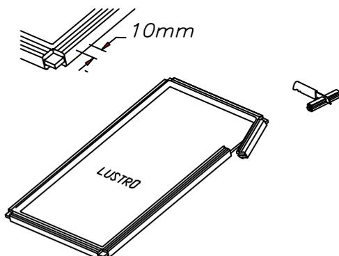
Le montage de la porte avec miroir est effectué d'une façon identique qu'avec le panneau, sauf qu'il faut mettre le joint sur le miroir avant le montage des traverses et des montants. La mode de fixation du joint et sa coupure aux angles du miroir est indiqué sur la figure à gauche.
