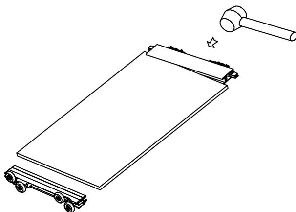
Mettez la traverse près du coin de panneau et le frappez à l'aide du marteau de caoutchouc pour l'insérer sur le panneau. Le montant doit être posé sur le panneau d'une façon centrale, c'est-à-dire les deux bouts de la traverse doivent avoir la même distance des bouts du panneau. Procéder d'une façon analogique avec le montage de l'autre traverse.
