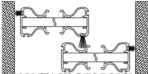
Insérez le joint brosse court dans l'enfoncement latéral du montant adhérent directement au mur ou au joue. Insérez le joint brosse long dans l'enfoncement de la paroi arrière du montant sur la porte extérieure, là où les portes chevauchent.
