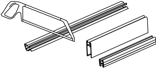
Calculez les dimensions des montants et des traverses selon les données définies dans le tableau à la page 1. Coupez les traverses et les montants à la longueur désirée.
