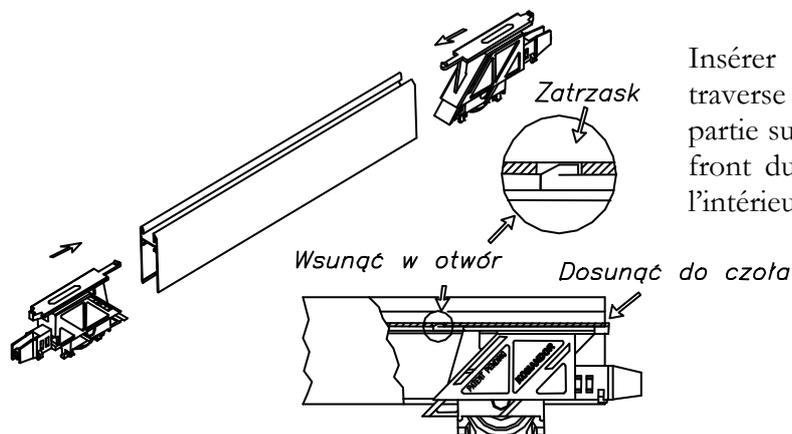
Pendant la fixation des connecteurs hauts à la traverse haute il faut procéder d'une façon identique que pendant la fixation des guides bas.
