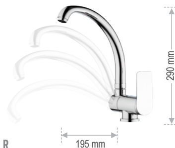
I 42 R Miscelatore monocomando monoforo 90° per lavello, con bocca alta, tipo lusso, modello sottofinestra. Single-lever one-hole sink mixer, with high spout, luxury type, under window type.
