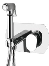
I 60 Miscelatore incasso per shut-off comprensivo di: doccetta shut-off art. 332OL, supporto doccia-presa acqua su piastra in ottone cromato e flessibile doccia cm 120. Built-in shower mixer set including: shut-off art. 332OL, shower holder water punch on flange all in c.p. brass and shower flexible cm 120.
